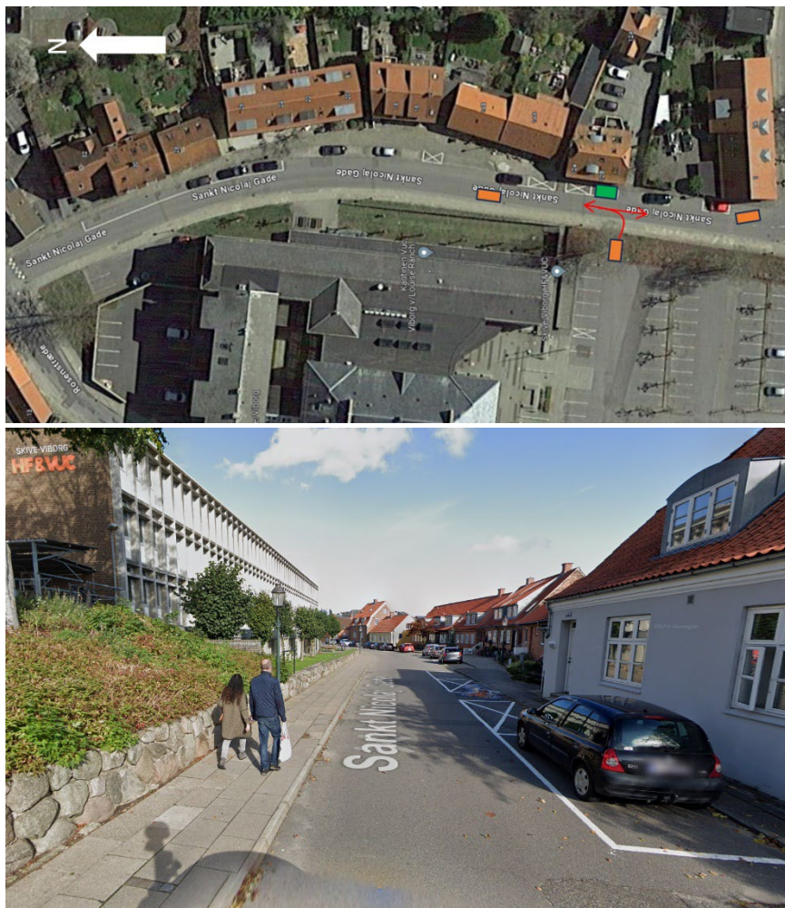
Figur 6-36 - Øverst: udkørsel fra parkeringshus (længdeparkering) - Nederst: Oversigtsforhold mod nord fra Parkeringshus – Google Streetview
