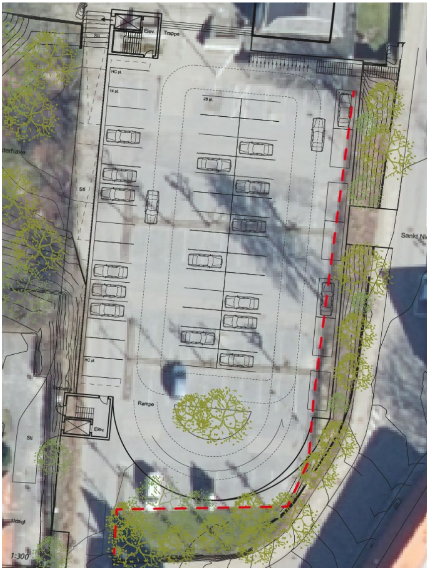
Figur 9-27: Kanten af den eksisterende skråning/beplantning markeret med stiplede rød linje over projektforslaget.
