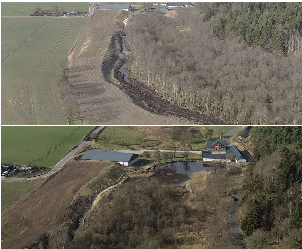
Den samlede vandføring løber nu i et nyt åbent vandløb ned langs møllesøen udenom opstemningen (ca. samme forløb som den tidligere drænledning)
